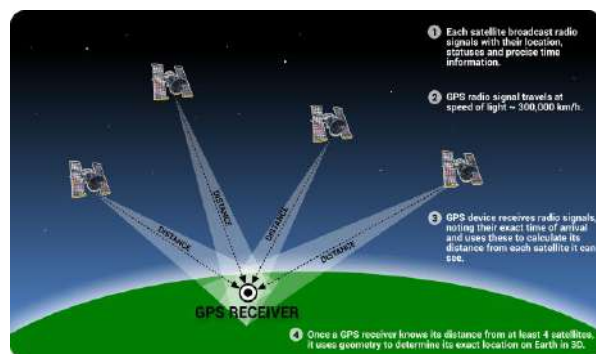
Abbildung 6-4 Berechnung einer Position aus 4 Satelliten (genecors)
