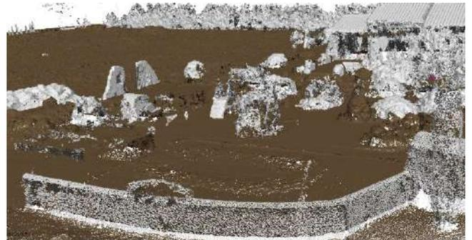
Abbildung 8-10 dichte Wolke Bodenklasse richtige Punkte
