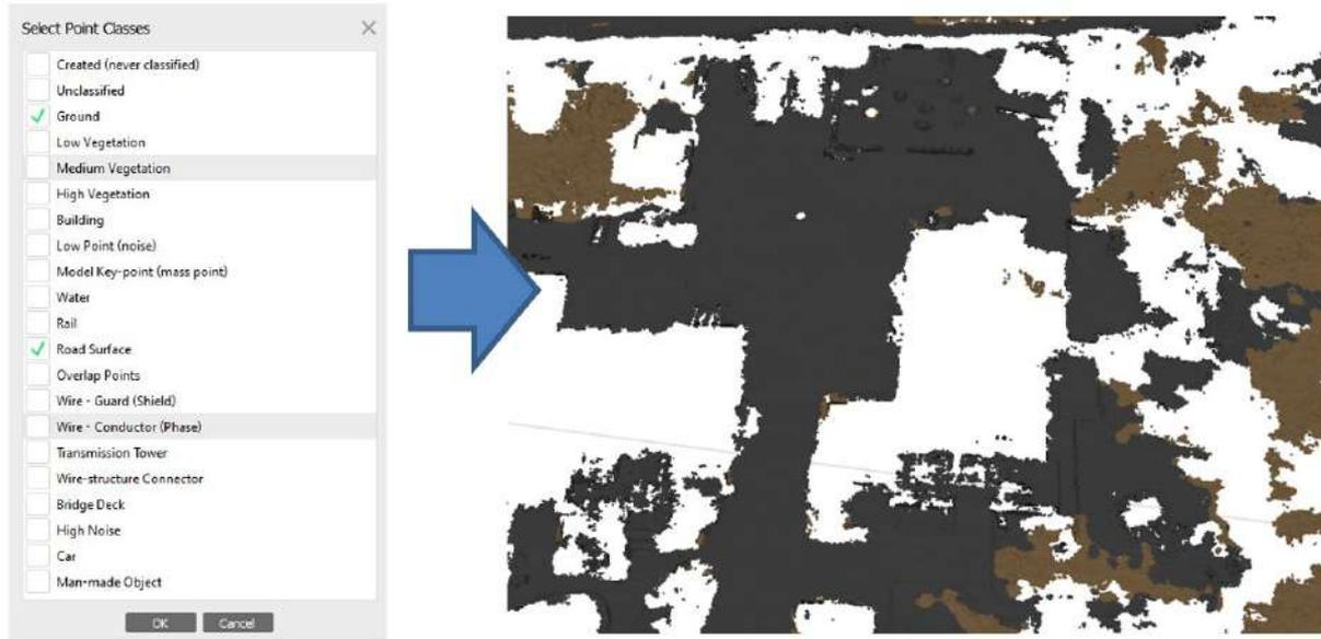
Abbildung 9-6 Punktwolke, die nur Boden und Straßenoberfläche anzeigt
