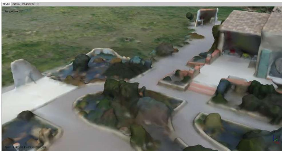
Abbildung 6-2 Netz mit "mittlerer" Flächenzahl
