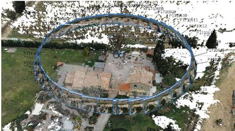
Abbildung 3-5 Rundflug einer Drohne für die 3D-Gebäudephotogrammetrie
