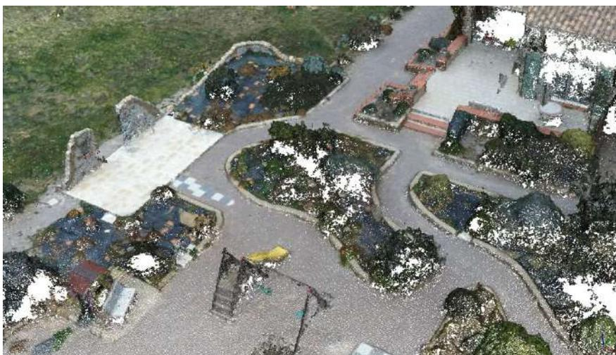
Abbildung 5-4 Metashape-Punktwolke mit weißen Lücken, in denen kein Punkt erstellt wurde
