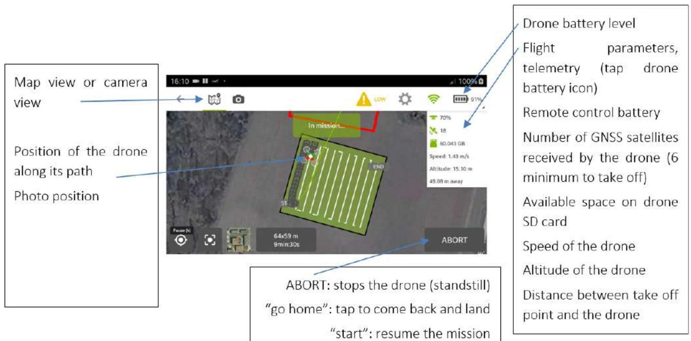
Abbildung 4-5 Pix4DCapture Missionsanzeige während die Drohne fliegt
