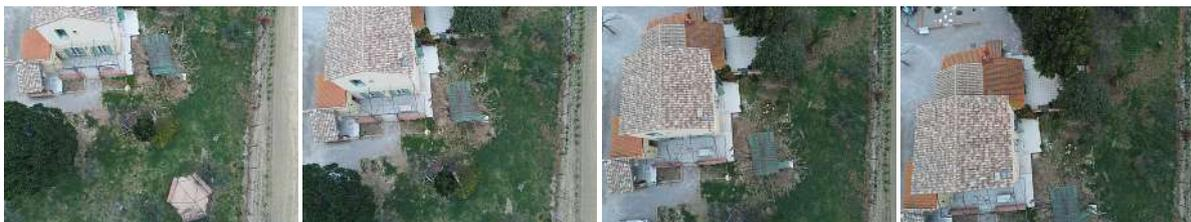
Abbildung 3-4 Fotosequenz mit guter Überlappung und Kameraneigung
