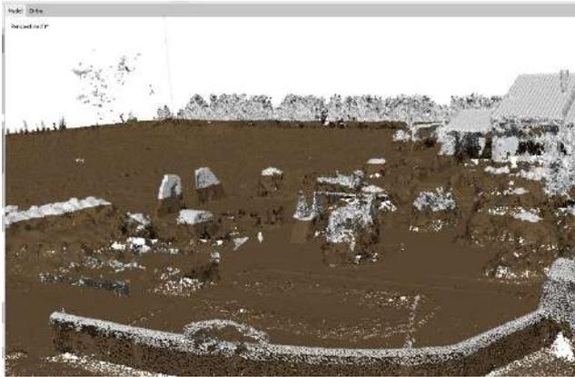
Abbildung 8-9 dichte Wolke Bodenklasse Punkte in der Nähe: Wände sind in der falschen Klasse wegen der "1m max Abstand" eingestellt
