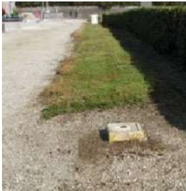
Figura 4-26 Punto de referencia geodésico de hormigón y bronce en Francia (IGN)
