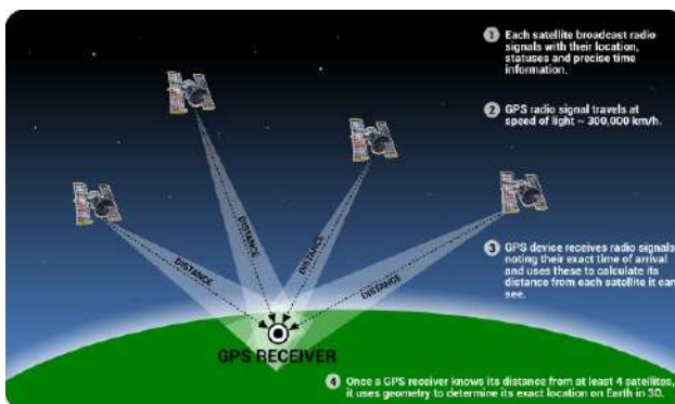
Figura 6-4 cálculo de una posición a partir de 4 satélites (genecors)
