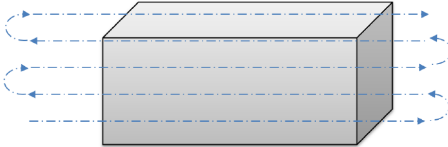
Figura 3-15 trayectoria para fachada y edificio 3D con extensión de los límites de las caras
