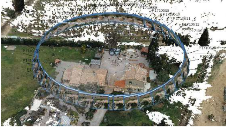
Figura 3-5 vuelo circular de dron para fotogrametría 3D de edificios
