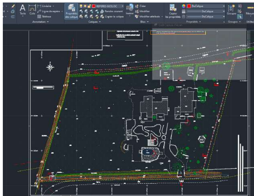
Figura 11-2 plano de la obra obtenido con el ortomosaico a escala en Autocad
