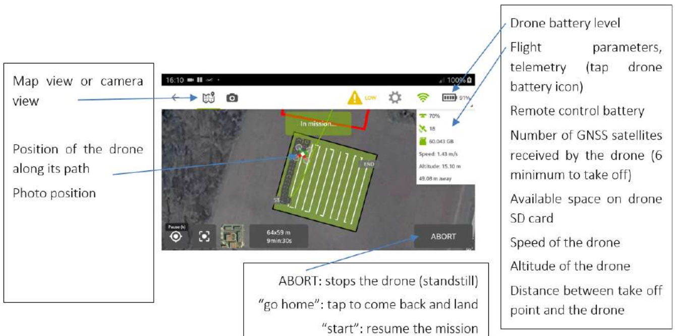
Figura 4-5 Visualización de la misión Pix4DCapture mientras el dron vuela
