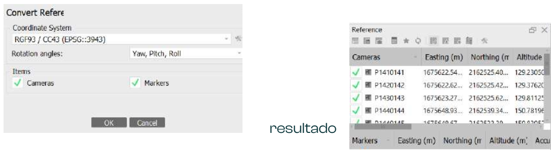
Figura 5-9 punto focal de las cámaras en el nuevo sistema de coordenadas
