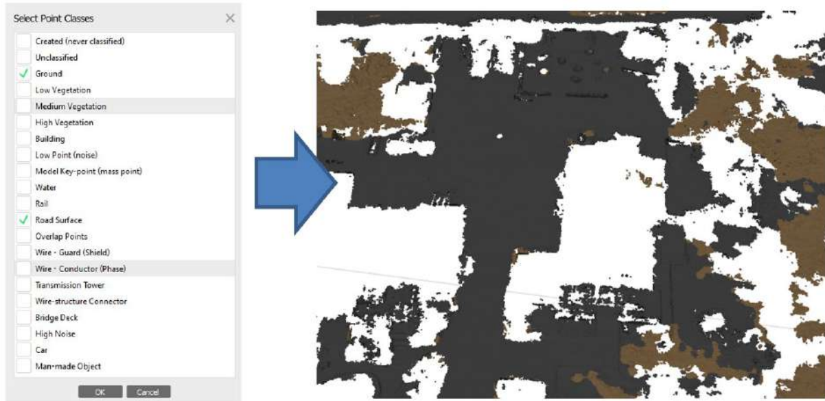
Figura 9-6 nube de puntos que muestra sólo el suelo y la calzada
