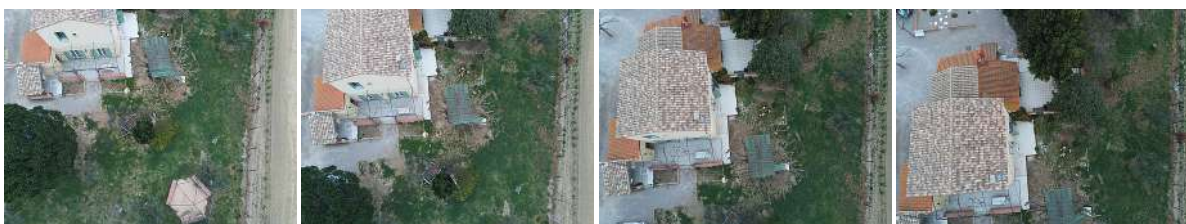
Figura 3-4 secuencia fotográfica con buena superposición e inclinación de la cámara
