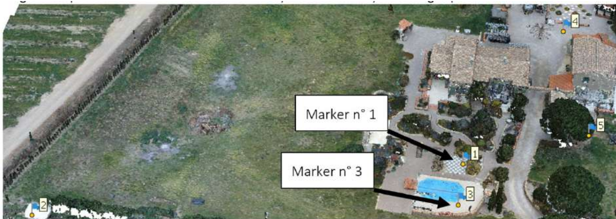
Figura 5-14 marcadores creados en la nube de puntos
