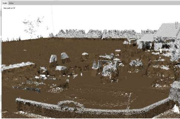
Figura 8-9 nube densa clase suelo puntos vistos cerca: paredes están en la clase equivocada debido a la "distancia máxima de 1m" establecida
