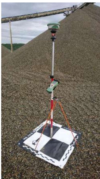
Figura 3-6 objetivo de geolocalización en tierra sondeado por GNSS Figura 3-7 objetivo de geolocalización terrestre con número
