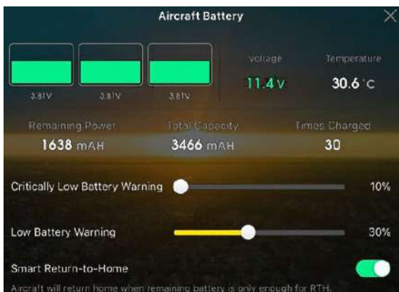
Figure 30 niveaux des cellules de la batterie (Volt)
