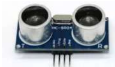
Figure 18 émetteur et récepteur d'ultrasons - eye4i.ch
