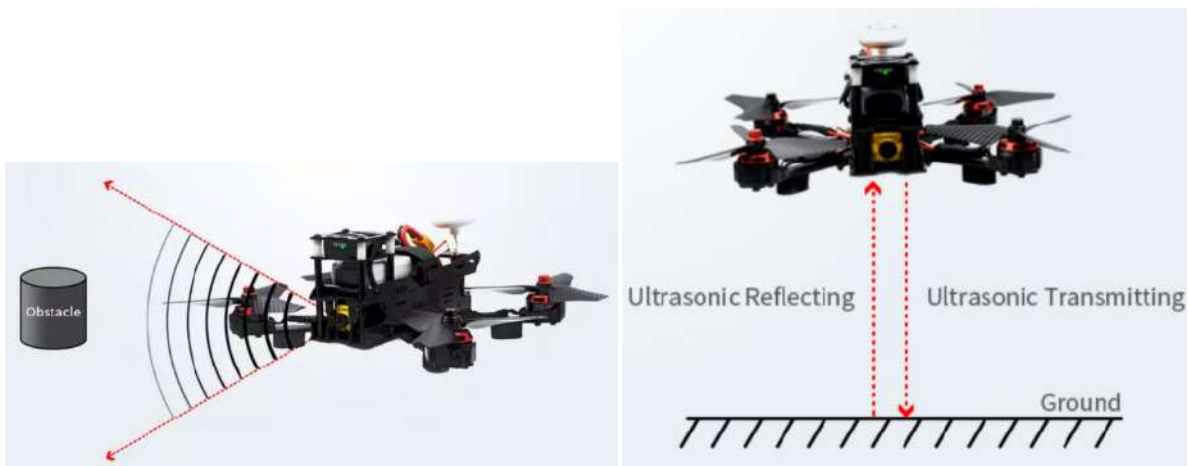
Figure 19 Détection ultrasonique verticale et horizontale - microcontrolertips.com
