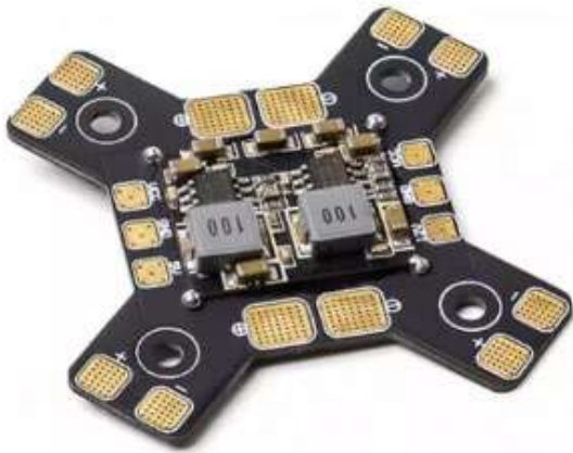
Figure 25 Carte de distribution d'énergie pour drone - hobbyking.com
