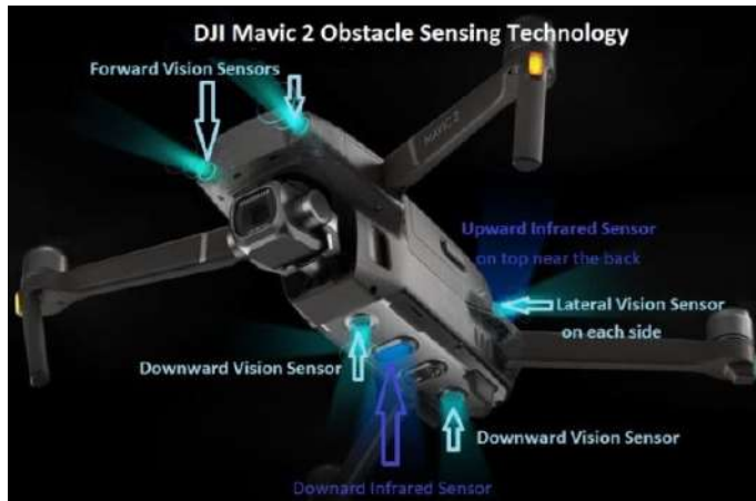
Figure 20 capteurs de proximité sur un drone (drone-festival.com)
