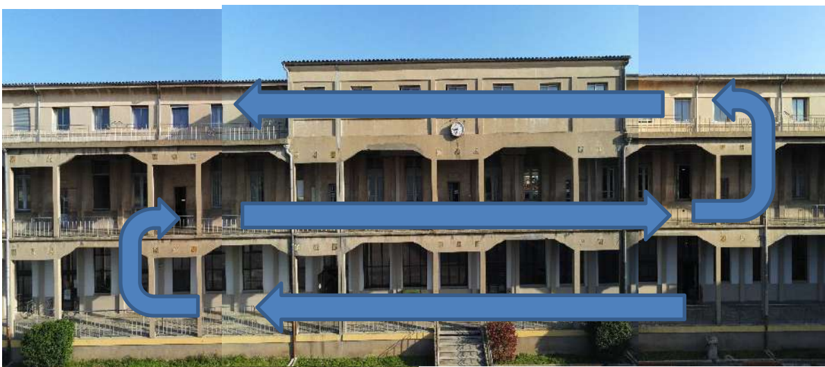
Figure 6-3 Trajectoire de levé de façade
