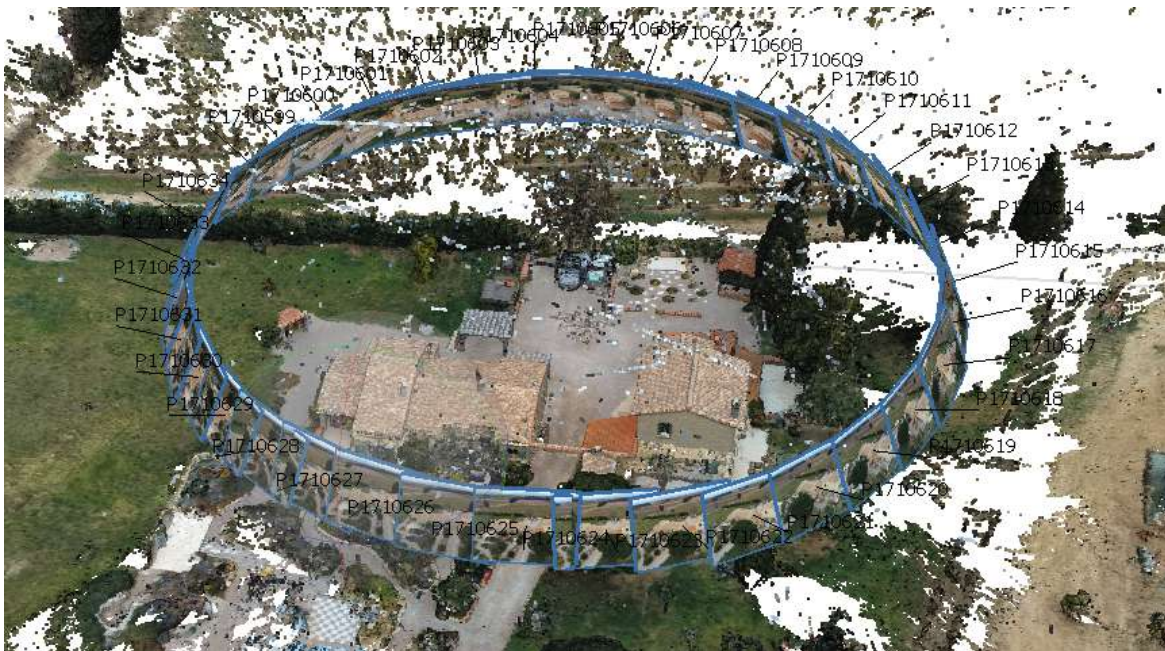
Figure 6-7 Déplacement autour d'un bâtiment pour la photogrammétrie 3D
