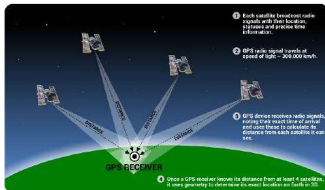
Figure 6-4 calcul d'une position à partir de 4 satellites (genecors)
