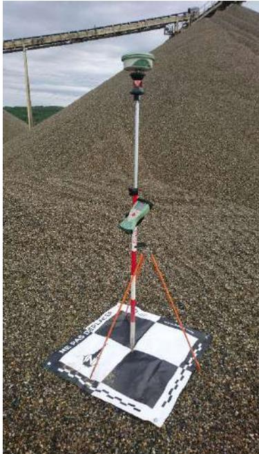
*Figure 7-2 Mesure GNSS sur une cible (Chivas)*
