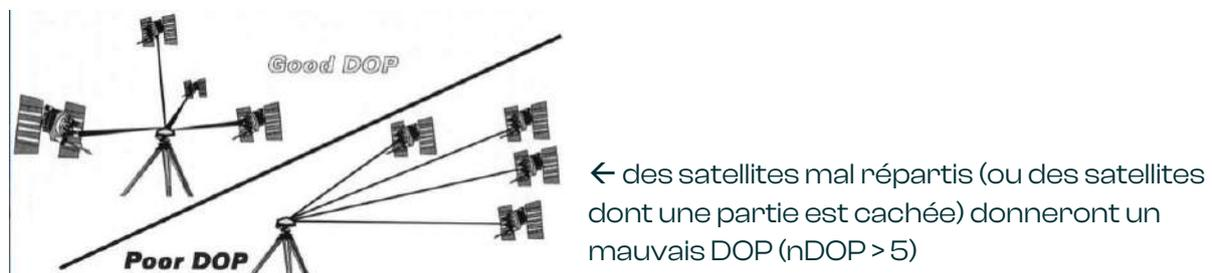
Figure 6- 5 DOP en fonction de la position des satellites (K.Ansari)
