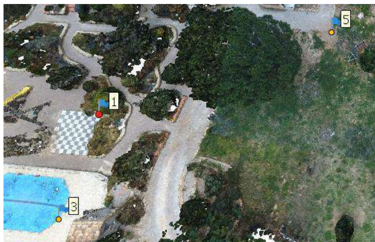
Figure 5-20 nuage de points mis à l'échelle et géoréférencé avec précision
