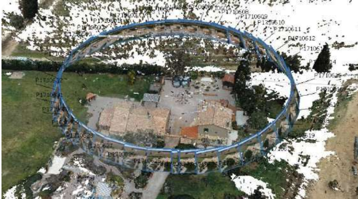
Figure 3-5 vol circulaire d'un drone pour la photogrammétrie 3D de bâtiments
