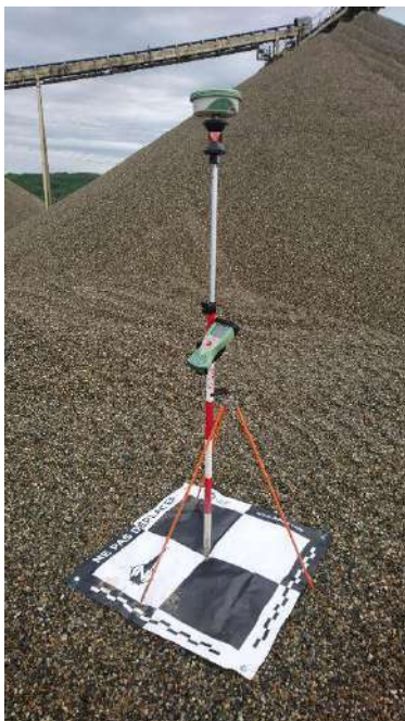
Figure 3-6 Cible de géolocalisation au sol relevée par GNSS
