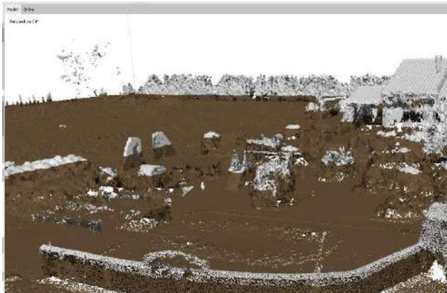
Figure 8-9 nuage dense classe de sol points vus de près : les murs sont dans la mauvaise classe à cause de la distance maximale de 1m.
