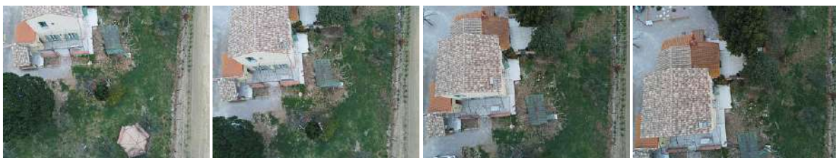
Figure 3-4 séquence de photos avec un bon chevauchement et une bonne inclinaison de l'appareil photo
