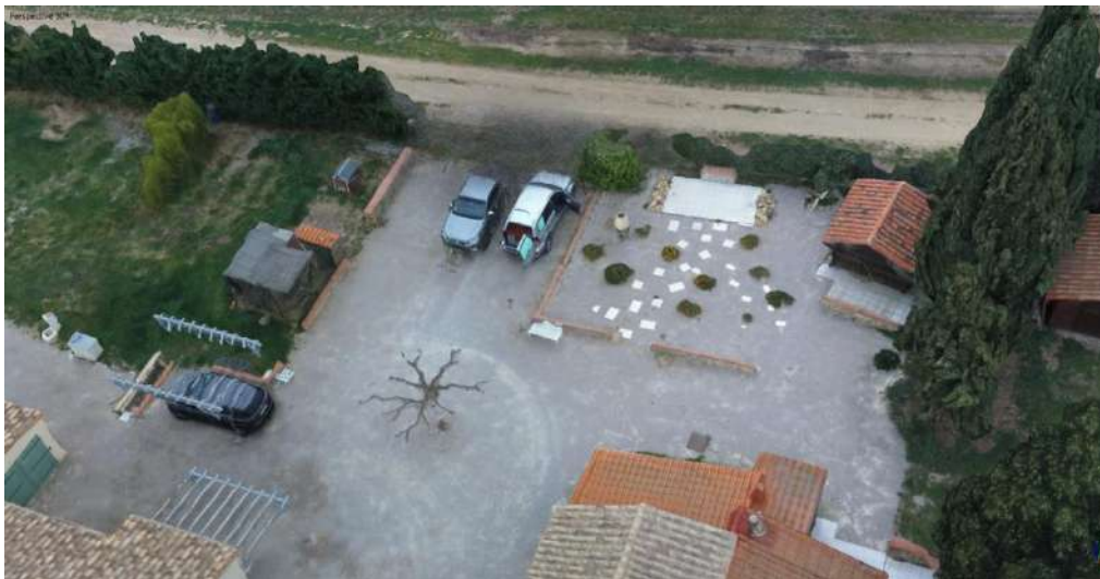
Figure 8-15 modèle tuilé. on y voit tous les éléments retirés par la classification pour obtenir le MNT
