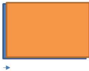
Figure 3-2 chevauchement erroné dû à un mauvais réglage du time-lapse ou à une vitesse incorrecte
