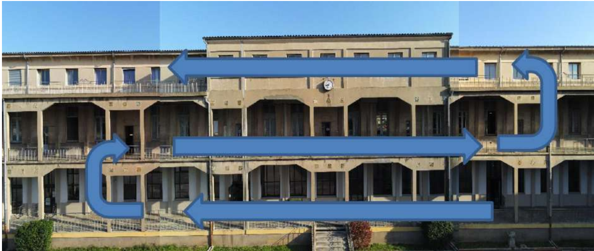
Figure 3-10 trajectoire de vol pour la photogrammétrie de façade
