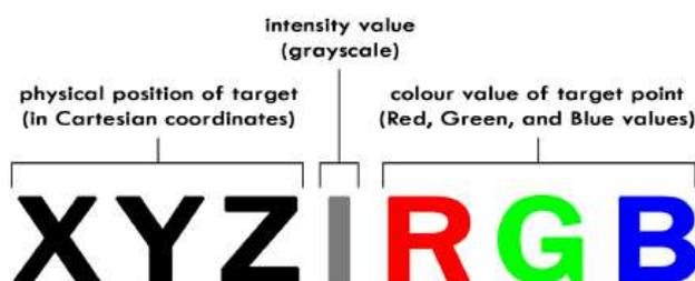
Figure 10 Formats des données LiDAR<sup>8</sup>
