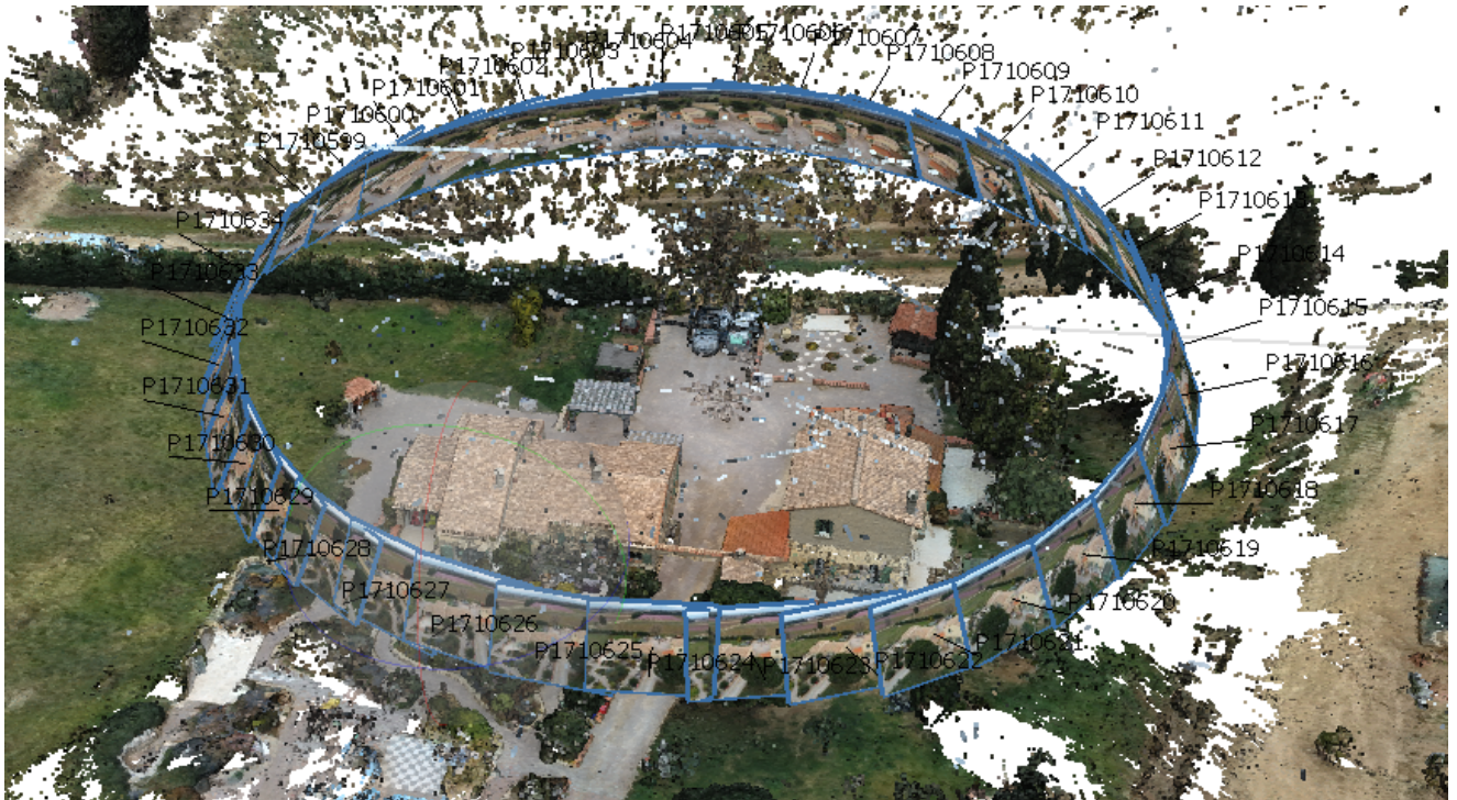
Abbildung 6-7 Umfahren eines Gebäudes für die 3D-Fotogrammetrie
