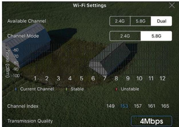
Figure 7 Réglage du canal WiFi (DJI)
