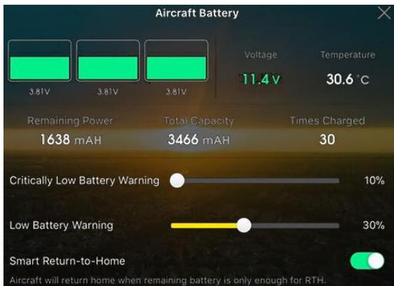
Figure 5 niveaux des cellules de la batterie (Volt)
