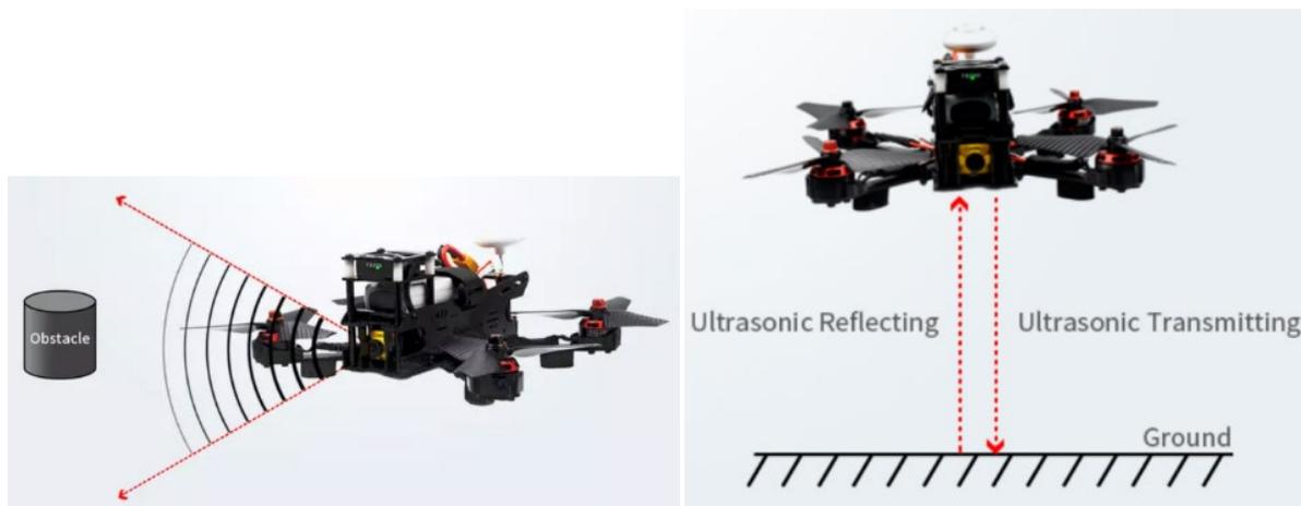
Figure 19 Détection ultrasonique verticale et horizontale - microcontrolertips.com
