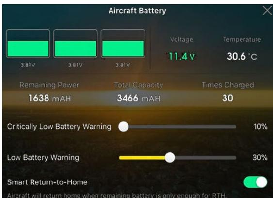
Figure 30 niveaux des cellules de la batterie (Volt)
