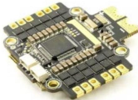
Figure 11 Contrôleur de vol - dronenodes.com
