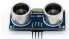
Figure 18 émetteur et récepteur d'ultrasons - eye4i.ch
