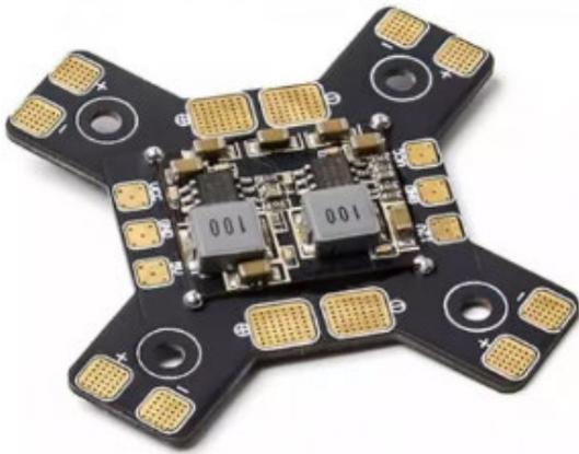
Figure 25 Carte de distribution d'énergie pour drone - hobbyking.com
