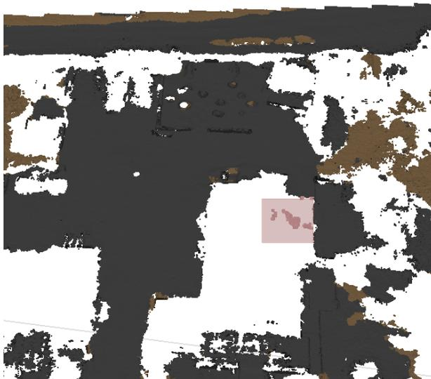
Figure 9-7 Sélection rectangulaire de quelques points mal classés
