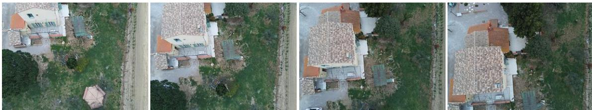
Figure 3-4 séquence de photos avec un bon chevauchement et une bonne inclinaison de l'appareil photo
