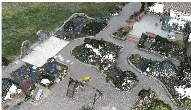
Figure 5-4 Nuage de points Metashape avec des espaces blancs où aucun point n'a été construit
