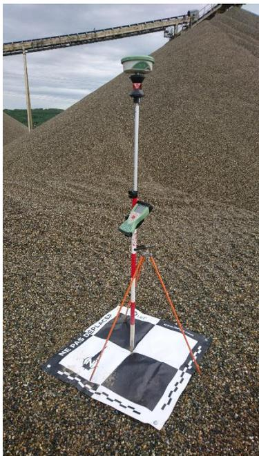
Figure 3-6 Cible de géolocalisation au sol relevée par GNSS
