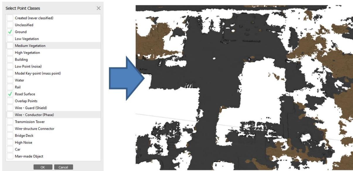
Figure 9-6 nuage de points affichant uniquement le sol et la surface de la route
