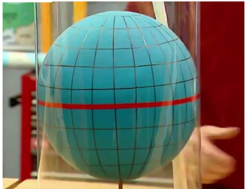
Abbildung 12: UTM-Projektion der Erdkugel auf einen Zylinder
